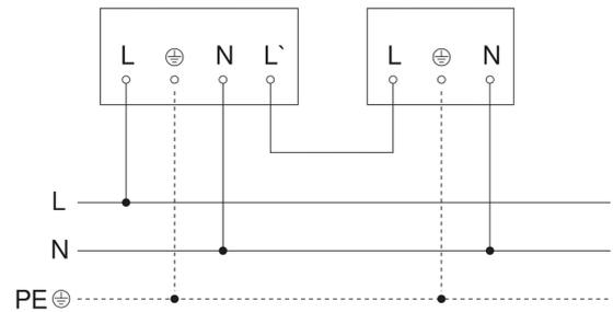
Schéma du circuit d'interconnexion maître/esclave
