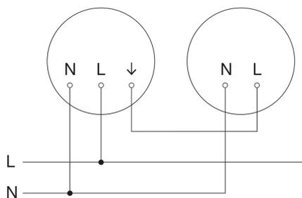
Schéma du circuit d'interconnexion maître/esclave
