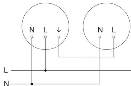
Schéma du circuit d'interconnexion maître/esclave
