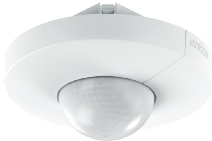
Starke Reichweite! Infrarot-Bewegungsmelder IS 345 für innen und aussen, ideal für Gänge, Flure, Funktionsräume, Montagehöhe bis zu 5 m, Erfassungsfeld 12 x 6 m (radial) und 23 x 6 m (tangential), starkes Relais für hohe Schaltleistung. Erhältlich jeweils in runder und eckiger Aufputz- und Unterputz-Ausführung.
