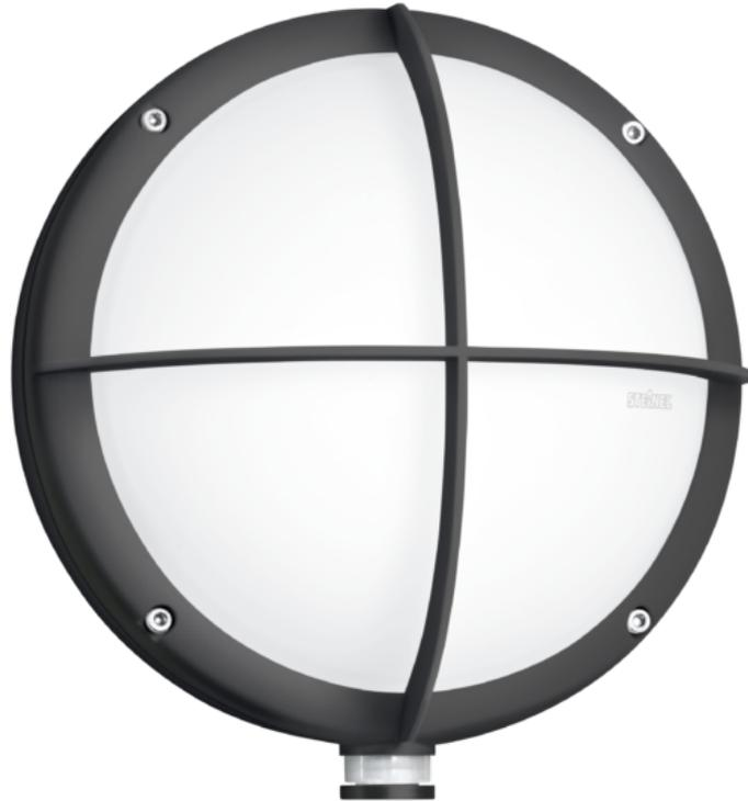
Rundum robust. Unempfindliche LED Sensor-Aussenleuchte aus witterungsbeständigem Kunststoff und schlagfester PMMA-Abdeckung inkl. zusätzlichem Schutzgitter. Die L 331 S sorgt mit ihrer runden Form, 3000 K Lichtfarbe und 711 lm bei nur 8,4 W rund ums Haus für optimale Lichtverhältnisse. Per Kabel sind mehrere Leuchten vernetzbar. Infrarot-Mini-Sensor mit vier Programmen. Erfassungswinkel: 360°. Reichweite max. 7m.
